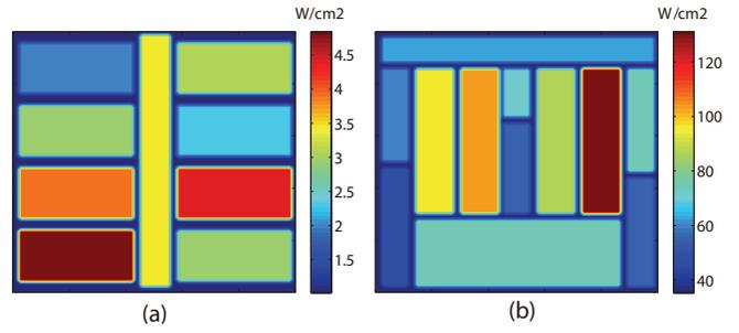
Fig. 12. Power maps (a)memory die (b)processor die
